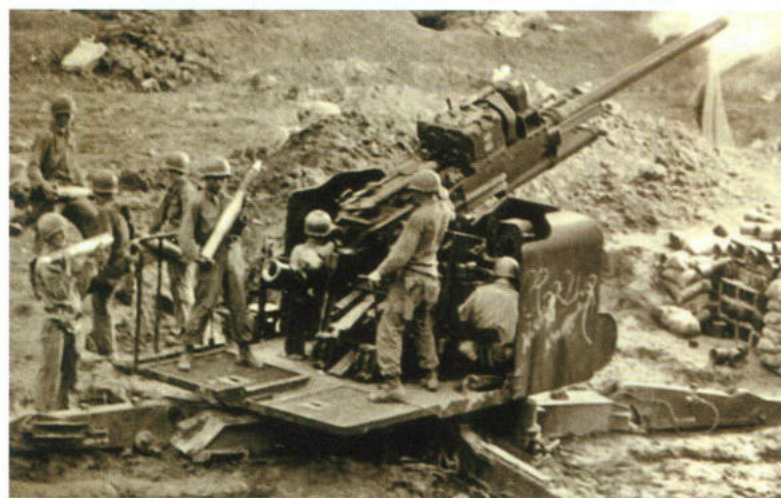
Американское 90-мм зенитное орудие M2, использующее с 1944 г. снаряды с радиовзрывателями
