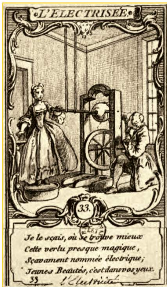
Электростатическая машина с шаровым натираемым телом.
