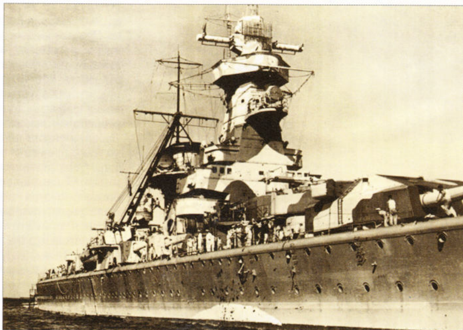
Рис. 5. Антенна радиолокатора Seetakt на башенке управления огнем линкора «Адмирал граф Шпее»
